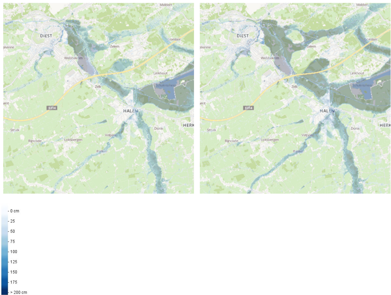
Figuur 17 | Waterdiepte in Halen, in cm (huidig klimaat en 2100)
